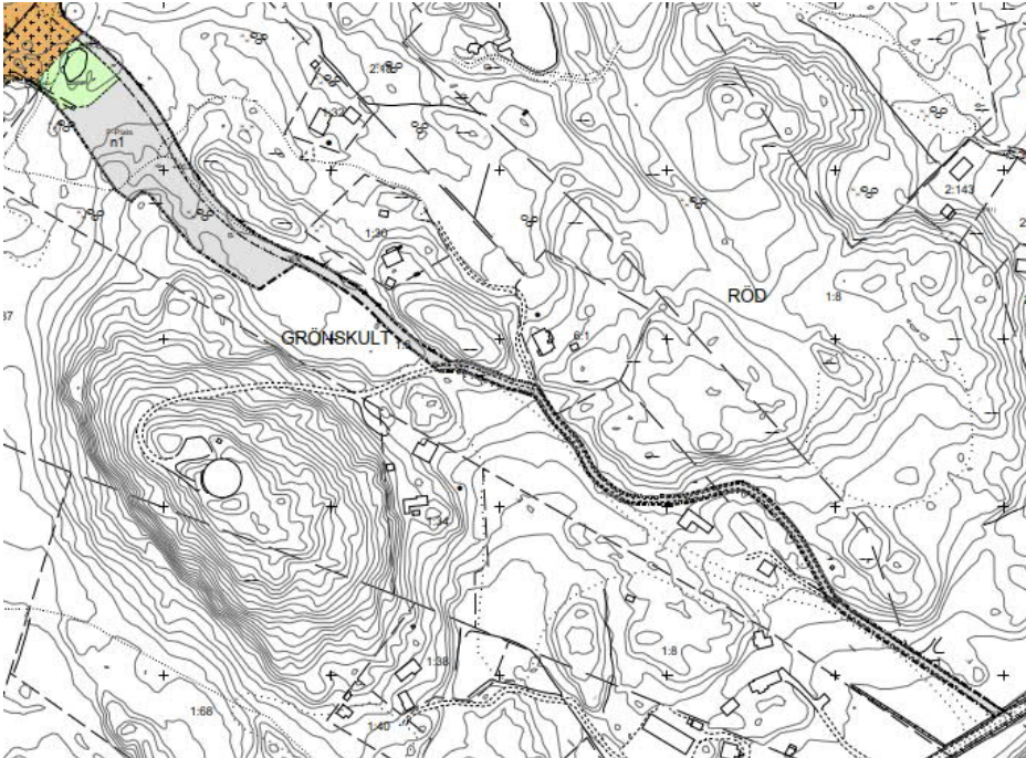
Figur 1 Tillfartsvägen passerar bergpartier men dessa kan hanteras med flacka vägsiånter eller bultning och bergrensning.
